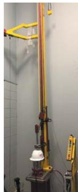
Machine pour test d'amortissement
